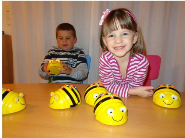
Die preisgekrönten Bodenroboter zeichnen sich durch eine einfache und kindgerechte Gestaltung aus. Programmiert werden sie über die Tasten auf ihrem Rücken. Möglich sind Bewegungen in Einheiten von 15 cm nach vorne und zurück sowie Drehungen um jeweils 90 Grad nach links und rechts. Dadurch ergeben sich einfache Ablaufmuster ohne komplizierte Winkel.
