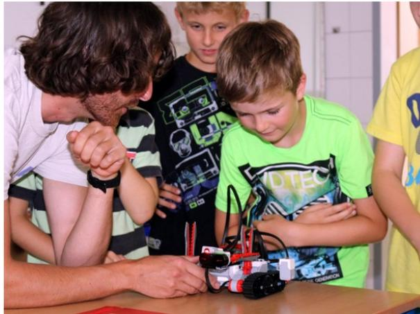
Die Baukästen des dänischen Lego-Konzerns beinhalten neben unzähligen Lego Technic-Bauteilen einen Mikrocontroller, an den sich verschiedene Aktoren und Sensoren anschließen lassen. Die Kinder und Jugendlichen können damit unterschiedlichste Robotermodelle konstruieren und anschließend das Verhalten ihrer Roboter über spezielle Computerprogramme programmieren.
