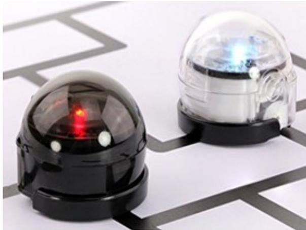
Der Ozobot ist ein kleiner Roboter mit eingebautem Akku und fünf Farbsensoren auf der Unterseite. Seine Programmierung ist ganz ohne Computer rein durch das Aufmalen von Linien möglich. Spezialfunktionen wie beispielsweise das Drehen am Stand lassen sich mithilfe vorgegebener Farbcodes abrufen. Weiterhin kann der Roboter über die graphische Entwicklungsumgebung OzoBlockly programmiert werden.
