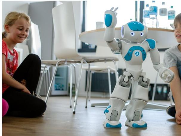
Beim NAO handelt es sich um den fortschrittlichsten humanoiden Roboter für den Ausbildungsbereich. Er hat 25 Motoren, zwei hochauflösende Videokameras sowie WLAN an Bord und erfasst seine Umgebung mittels verschiedenster Sensoren. Neben Sprach-, Gesichts- und Objekterkennung kann der NAO-Roboter auch mehrsprachig kommunizieren. Die Programmierung ist in unterschiedlichen Umgebungen und Sprachen möglich.
